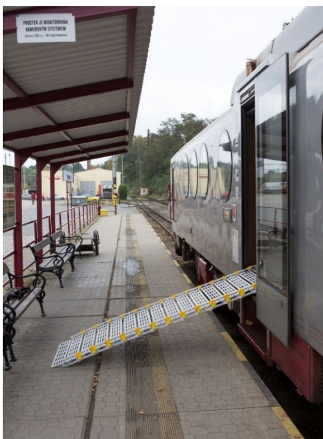
Obrázek 3.4 – Nevhodné použití přenosné rampy [7]
