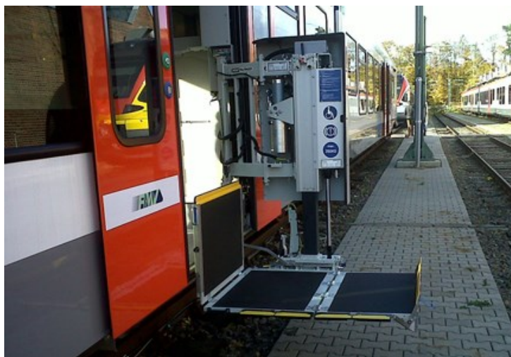
Obrázek 5.1 – Plošina Palfinger Trainlift TRP 600 [13]
