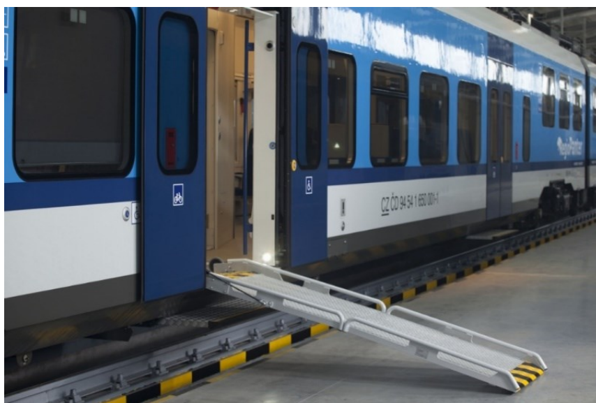
Obrázek 3.1 – Integrovaná rampa soupravy RegioPanter [5]
