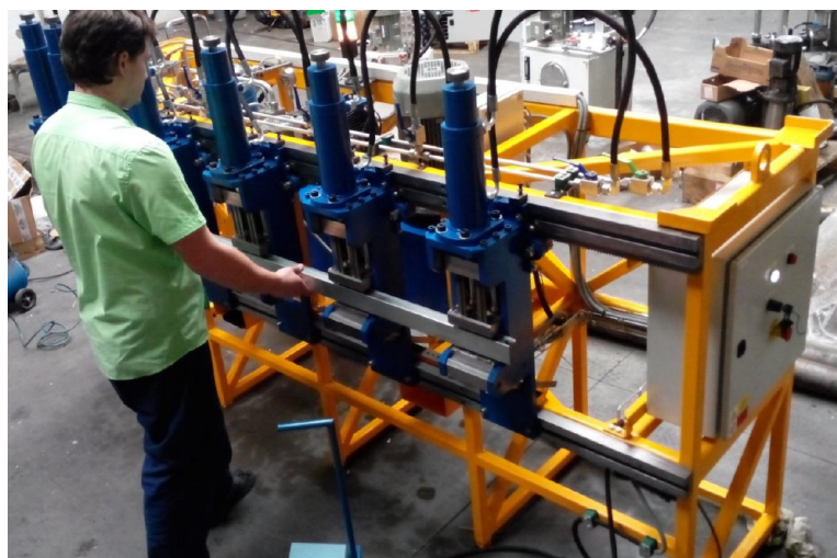
Obr. 1.5 – Aretace profilu operátorem
