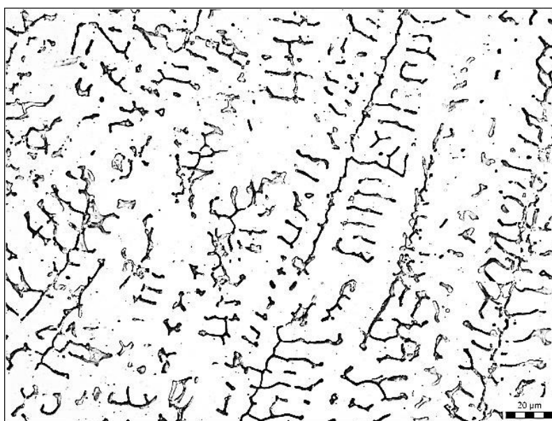
Obrázek 39 – Vzorek B, detail svarového kovu (500× zvětšení)
