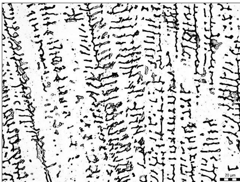
Obrázek 53 – Vzorek C, detail svarového kovu (500× zvětšení)
