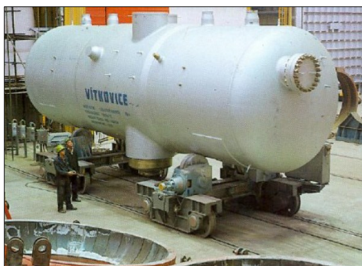
Obrázek 6 – (nalevo) parogenerátor DN 1100, (napravo) heterogenní svarový spoj kolektoru [8]
