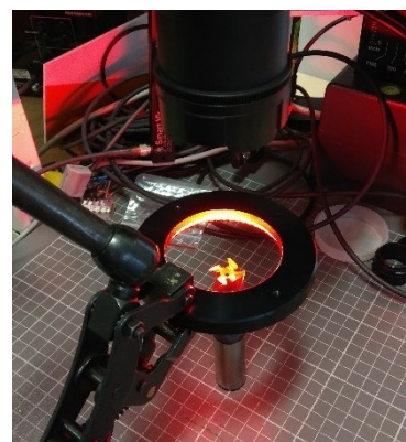
Obrázek 18: a) Prototypová měřící sestava b) Kamerová sestava pro snímání počtu břitů
