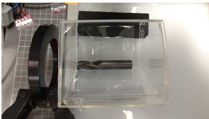
Obrázek 18: a) Prototypová měřící sestava b) Kamerová sestava pro snímání počtu břitů
