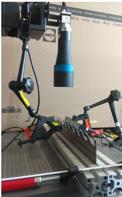
Obrázek 30: Sestava pro snímání pilových listů
