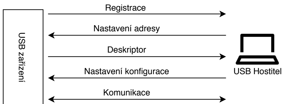
Obrázek 4: Navázání komunikace mezi USB zařízením a USB hostem
