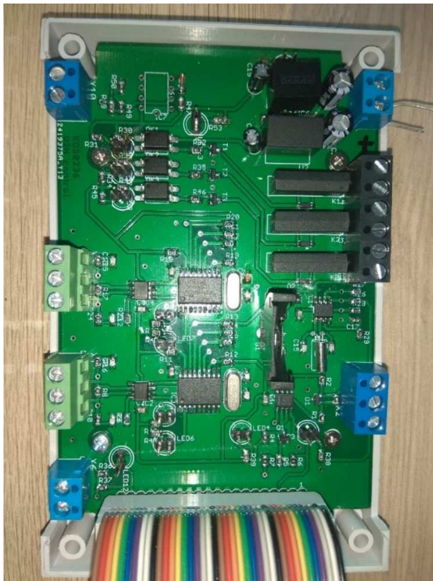
Obr. 3-13 Osazená DPS řídicí jednotky EFCU
