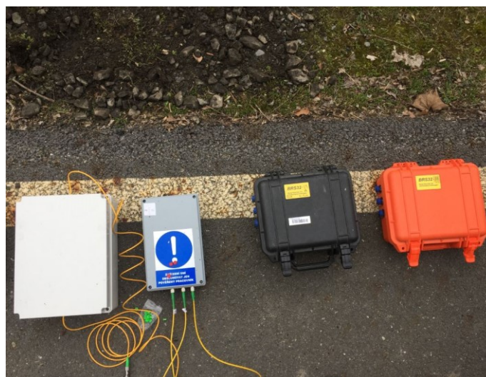
Obrázok 7.3: Interformetre a seizmická stanica (z ľava: nami vytvorený MZ senzor, trojramenný senzor, dve časti seizmickej stanice).
