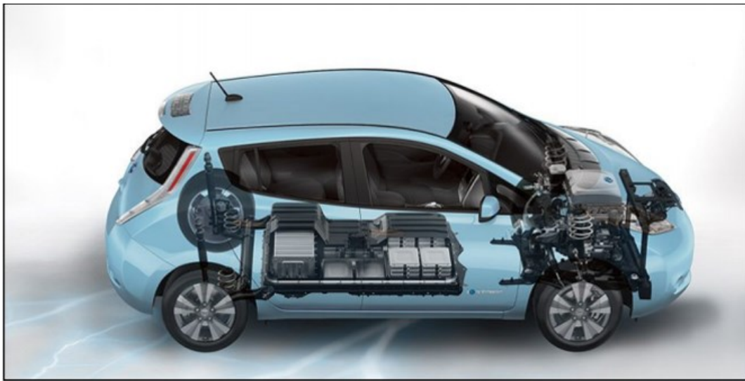
Obrázek 2- Uspořádání hlavních konstrukčních částí elektromobilu
