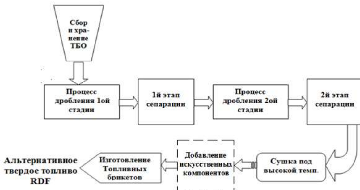
Рисунок 1 – Схема технологического цикла производства RDF
