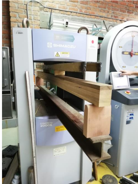
Figura 33. Ensayo a flexión viga de Canelo con láminas continuas.
