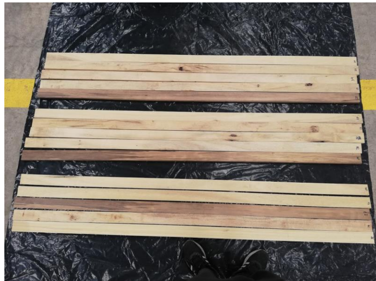
Figura 38. Defectos en los listones de Canelo.
