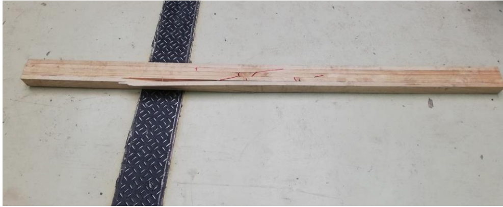
Figura 45. Falla por tensión, viga Pino Insigne #1.
