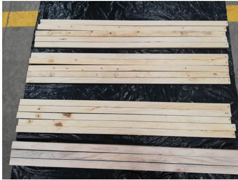
Figura 35. Defectos en los listones de Pino Insigne.
