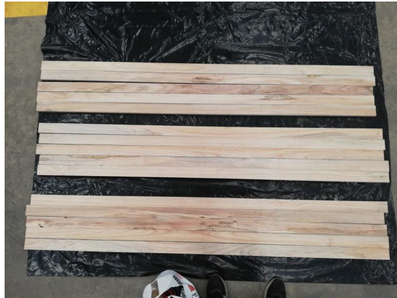
Figura 40. Defectos en los listones de Fernán Sánchez.
