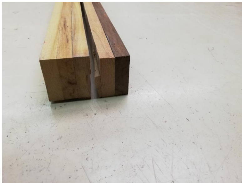
Figura 46. Falla por corte horizontal, viga Canelo #2.
