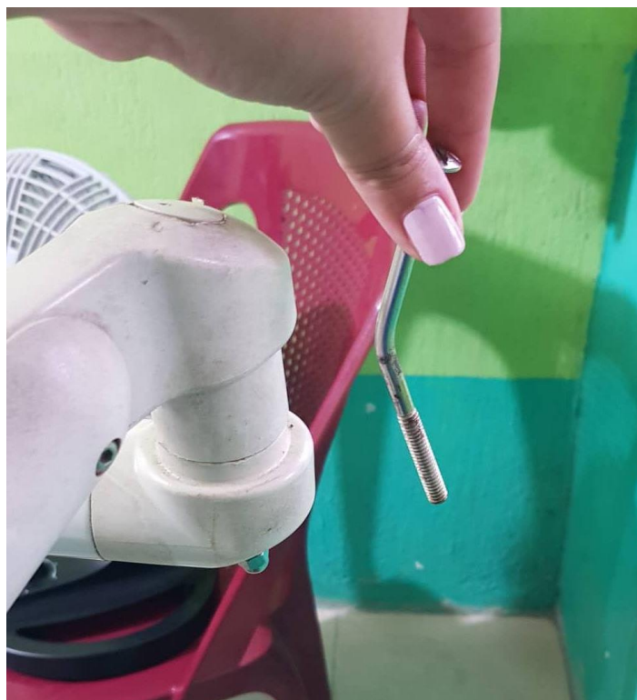
Imagen No.6 Mejoras a la clínica del Centro de Salud de San Vicente Pacaya, Escuintla EPS 2018-2019 Septiembre, cambio del tornillo del bracket, debido a desfase.
