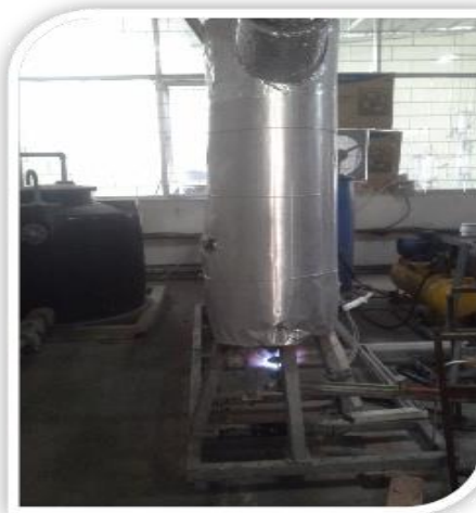
Gambar 7. Uji coba gas hasil samping pirolisis pada burner alat pirolisis
