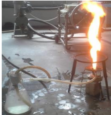
Gambar 3. Nyala api setelah purifikasi menggunakan larutan \text{Ca}(\text{OH})_2
