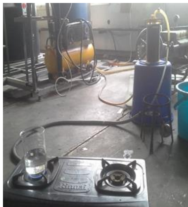
Gambar 4. Nyala api setelah purifikasi menggunakan kolom purifikasi
