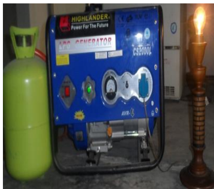
Gambar 8. Uji coba gas hasil samping pirolisis pada genset
