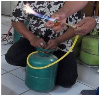
Gambar 6. Uji nyala setelah penabungan gas hasil pirolisis limbah plastik
