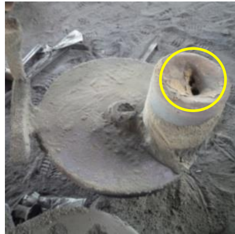
Gambar 11. Shrinkage terjadi pada riser
