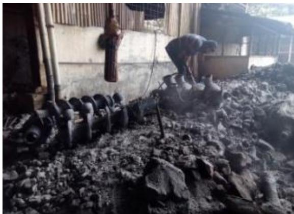
Gambar 10. Pembongkaran *screw press* dari cetakan
