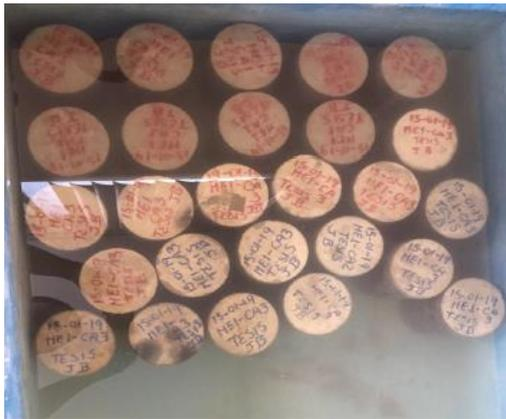
Figura 2. Curado de Cilindros.
