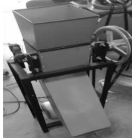
Figura 9. Estructura con tolvas y caja de cuchillas montadas.
