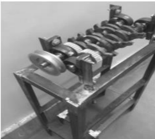
Figura 8. Sistema de ejes, cuchillas, piñones y chumaceras montado en la estructura.
