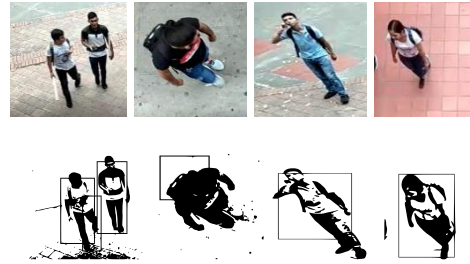
Fig. 2. Aplicación de un detector en cascada de cuerpo completo
