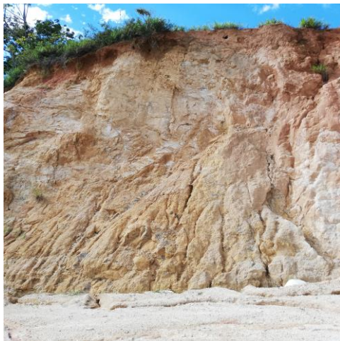
Fig. 2. Perfil de meteorización típico de los suelos de la formación ígnea presente en la ciudad de Ocaña.
