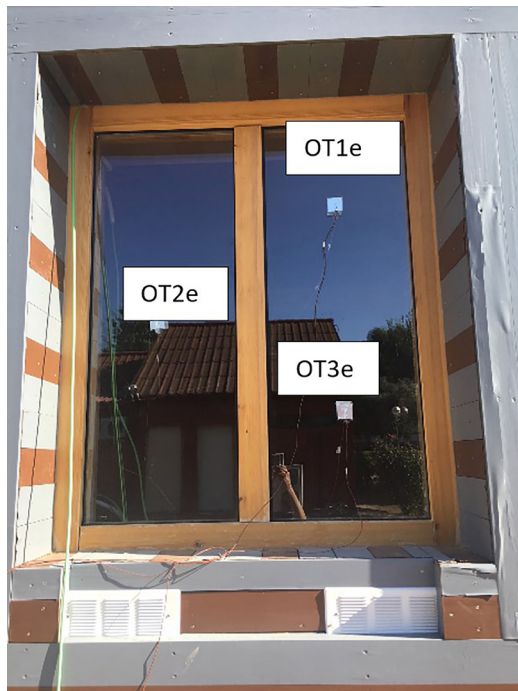
Figura 12. Posición de los termopares en los acristalamientos. Ventana Optimizada.
