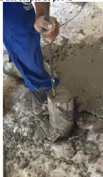
(b) Adensamento do corpo de prova
