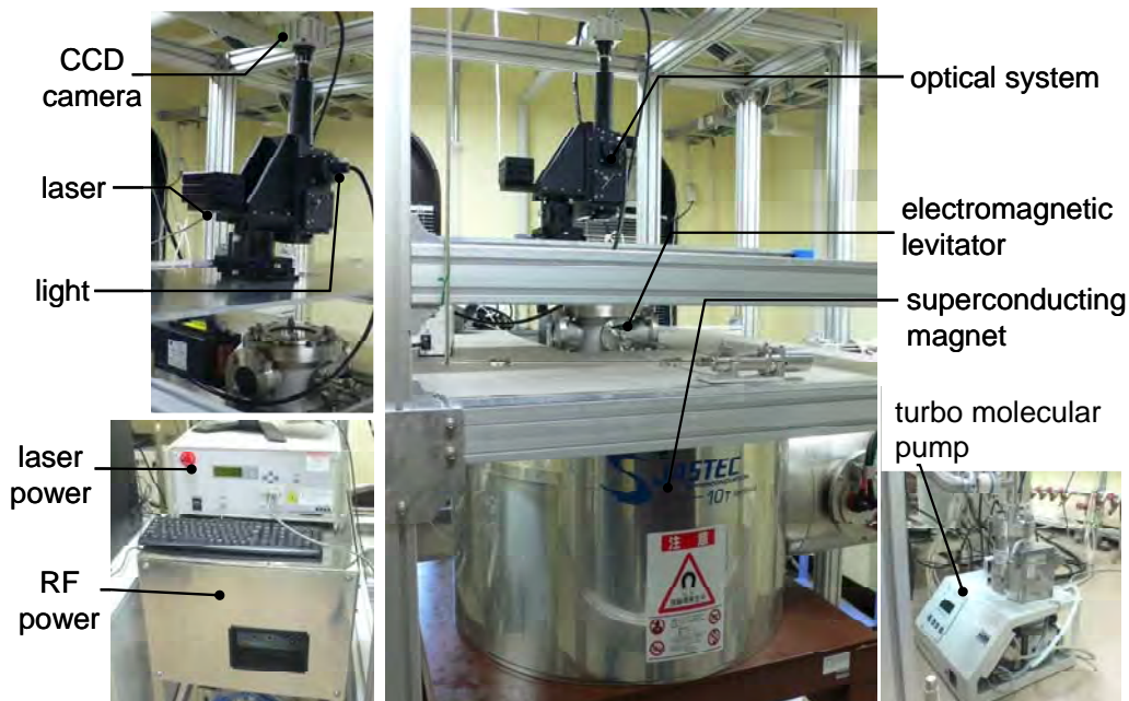
図 3 超高温熱物性計測システム PROSPECT
