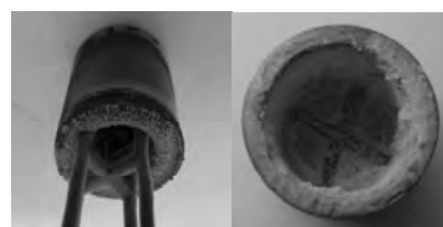
図 4 W 内筒に析出した GaN 雑晶
