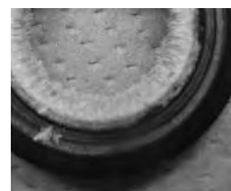
図 3 Ni 基合金ガスケットに析出した GaN 雑晶
