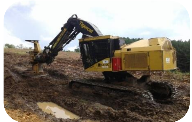
Figura 1. Feller buncher utilizado para o corte florestal de povoamentos de pinus e eucalipto.
