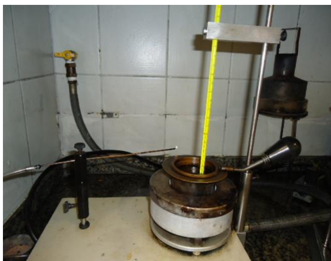
FIGURA 2 – Ensaio do ponto de fulgor e combustão do óleo de coco babaçu bruto (ABNT NBR-11341).
