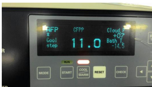
FIGURA 2. Resultado de teste branco (11 °C), utilizando-se um Ponto de Entupimento de Filtro a Frio, modelo AFP- 102 da marca Tanaka. Amostra 06/2016 Fornecida por JBS.
