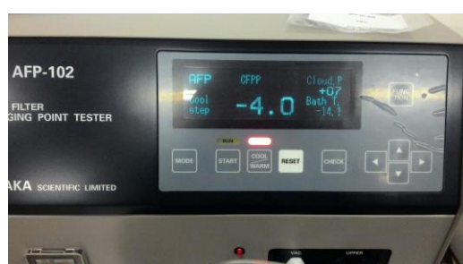
FIGURA 3. Melhor resultado em aplicação normal (-4°C), utilizando-se um Ponto de Entupimento de Filtro a Frio, modelo AFP- 102 da marca Tanaka. Amostra 06/2016 Fornecida por JBS.
