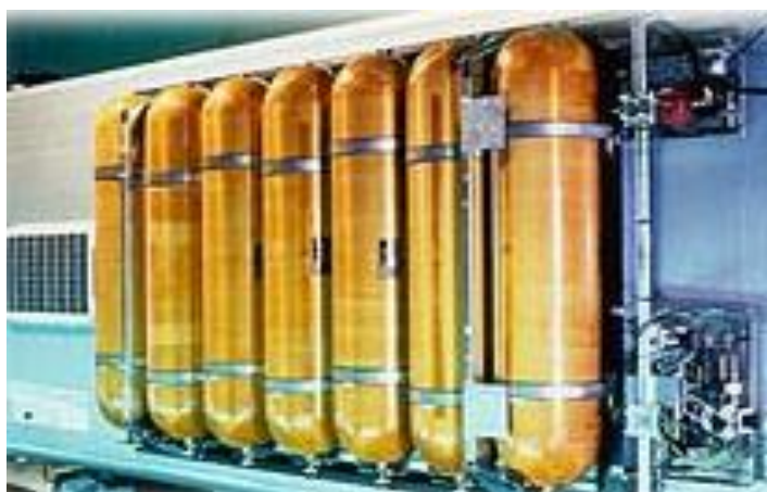
Figura 1. Reservatório de gás comprimido
