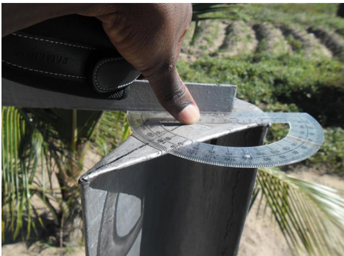
Figura 2: Apresenta o método utilizado para o ajuste do ângulo das pás.
