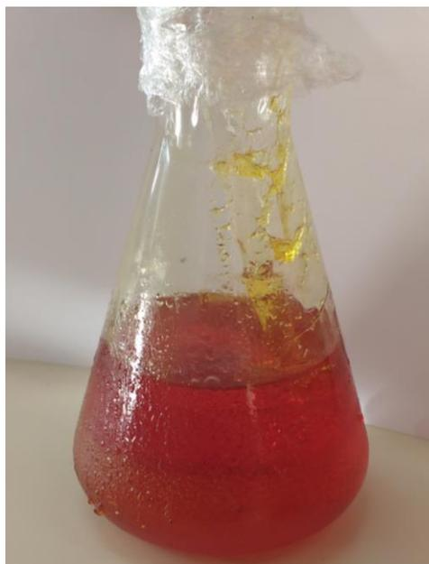
**Figura 3.** Óleo de pinhão-manso sem adição de cobre, papel Kraft e antioxidante, após 96 h de envelhecimento acelerado (ensaio 1)
