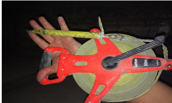
FIGURA 6 – Trena métrica com o peso em sua extremidade.
