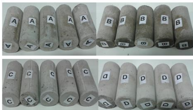
FIGURA 4: CORPOS DE PROVA DE CONCRETO PARA ENSAIO DE COMPRESSÃO
