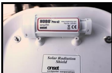
Figura 5 - Sensor HOBO Pro V2 U23-001
