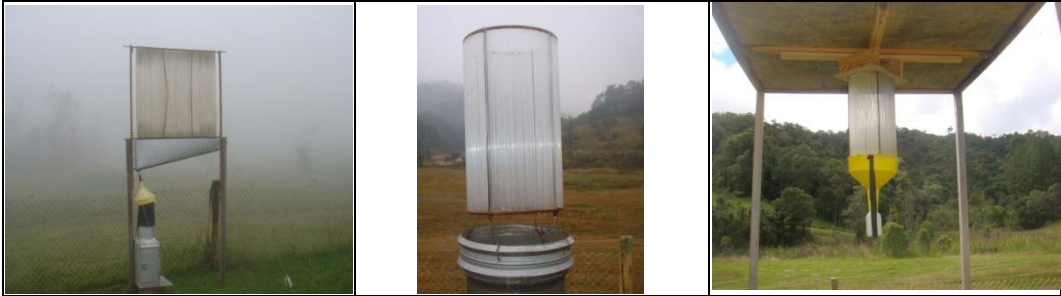
Figura 2 - Coletores de água de nevoeiro no posto meteorológico do LHFWE.
