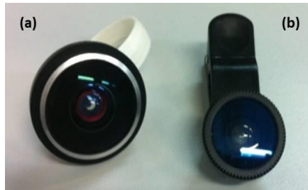
Figura 2 - Lentes olho-de-peixe alternativas para celulares. Fonte: Imagens produzidas pelos autores
