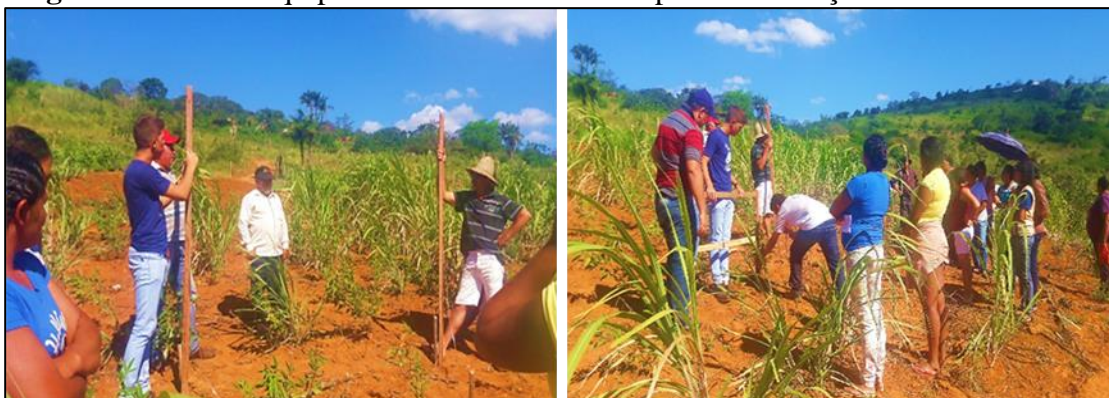
Figura 5. Uso dos equipamentos confeccionados para demarcação de curva de nível.
