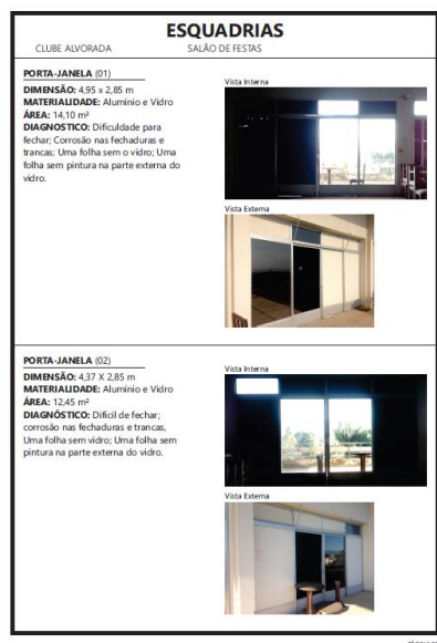
Figura 10 —Modelo do levantamento das esquadrias com a identificação de materialidade e diagnóstico.
