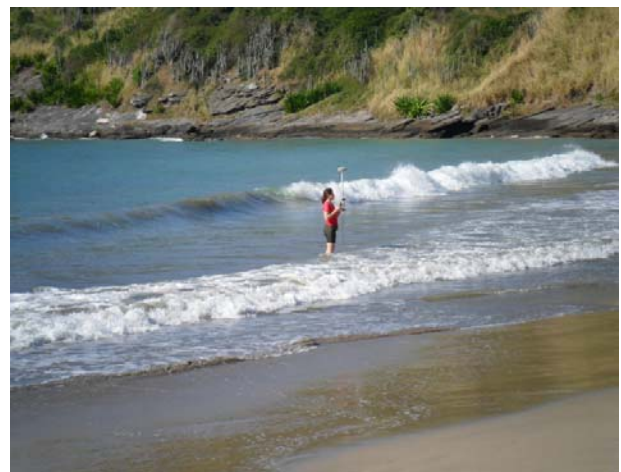
Figura 4: Aquisição de dados com utilização de DGPS no modo semicinemático na face da praia
