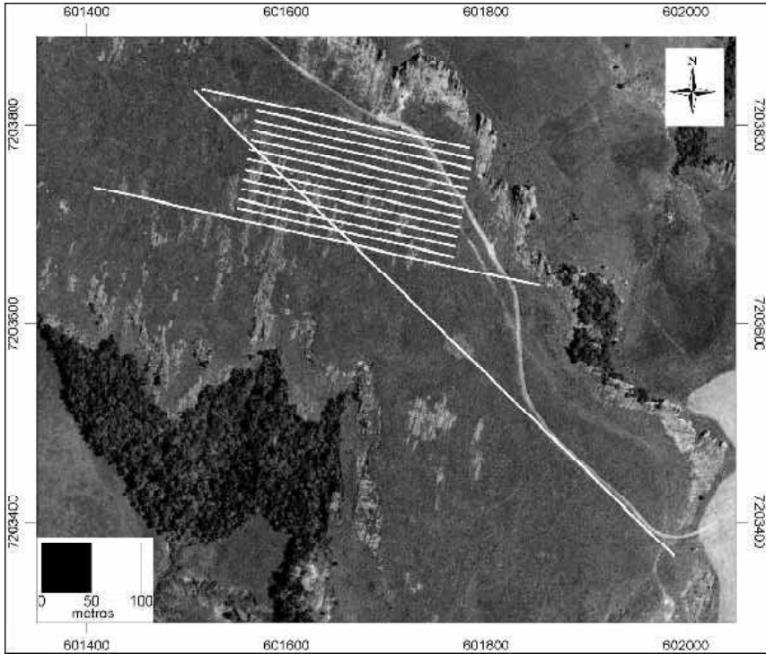
Figura 5 – Fotografia aérea com o posicionamento das linhas de levantamentos geoeletricos. Aerial photograph with the resistivity survey lines.
