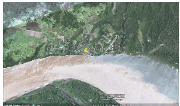
**Figura 3** – Neste segmento do rio Madeira, a combinação da margem côncava com o aumento do fluxo, velocidade e o estreitamento do canal, contribuem para a ocorrência do fenômeno das “terras caídas”. Fonte: Google Earth
