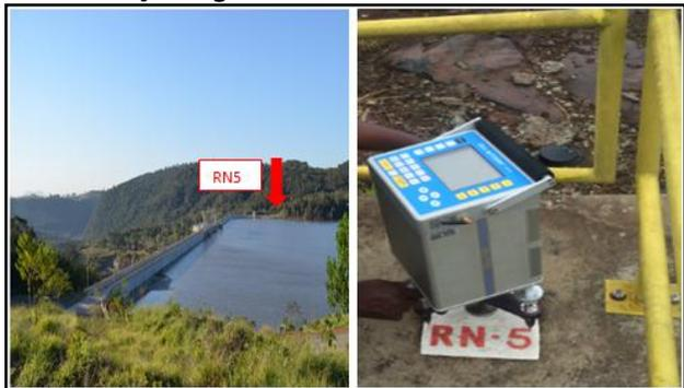
**Figura 4** - Estação gravimétrica de referência RN-5.
