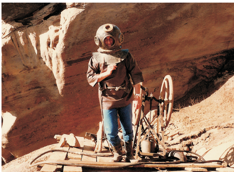
Figura 2 – Aspectos típicos das técnicas de recuperação de diamantes do leito ativo no Rio Tibagi: mergulhador com escafandro para trabalhos mecanizados no fundo do rio. Foto D. Mesquita, 1985.
