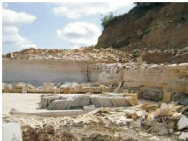
**Figura 22** – Bacia do Araripe: Mina Pedra Branca, onde as lajes de calcário laminado (ou pedra cariri) são extraídas. Através desta atividade, fósseis são encontrados diariamente. (Fotografia: Aline Castro, 2012).
