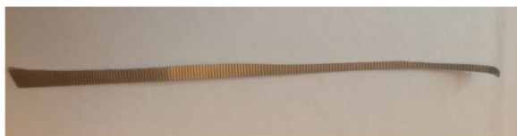
Figura 2 – Régua milimétrica de aço inox com 20 cm de comprimento, 0,6 mm de espessura, 2 mm de largura na extremidade e 4 mm na base com seus 4 mm finais angulados.
