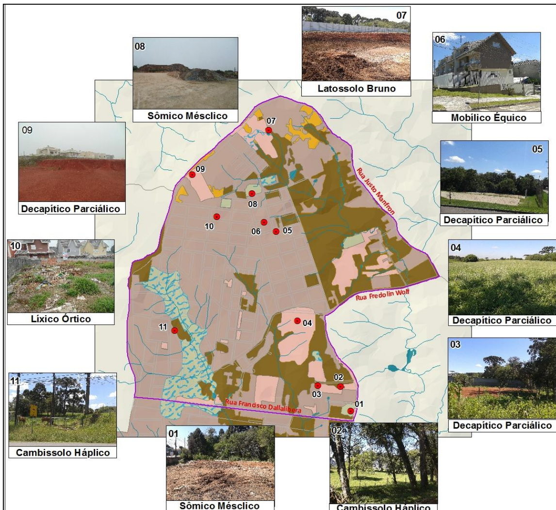
Figura 6 – Identificação dos Solos Alterados.
