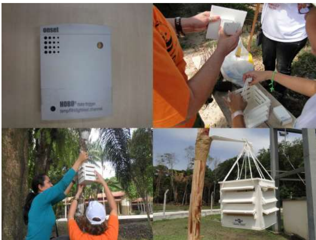
Figura 3. Instalação dos mini-abrigos agrometeorológicos para monitoramento térmico – hídrico no Bairro Mutirão, Abaetetuba, Pará (14/12/2013 a 06/01/2014).
