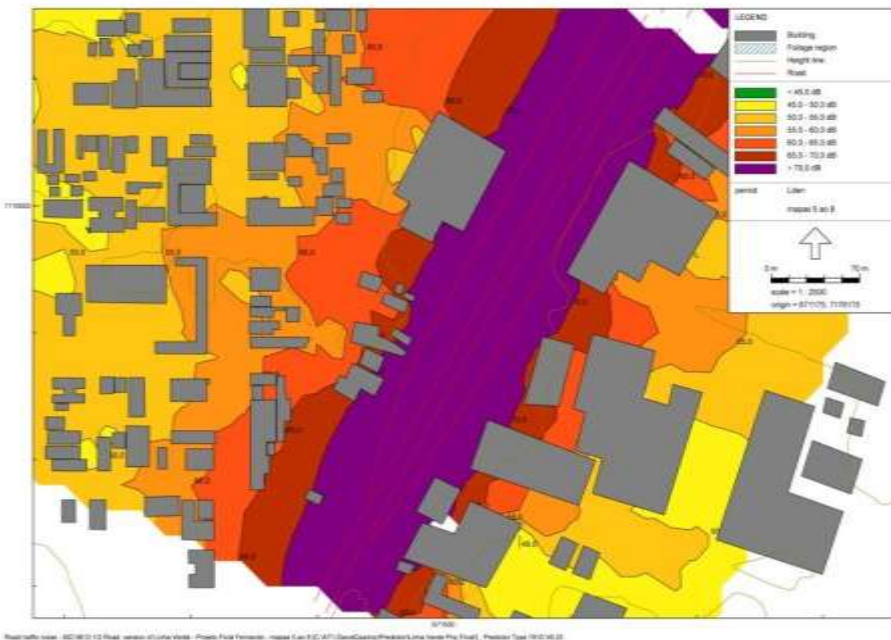
FIGURA 15: NÍVEIS DE PRESSÃO SONORA EQUIVALENTE OBTIDOS ATRAVÉS DE SIMULAÇÃO COMPUTACIONAL PARA O PONTO 5
