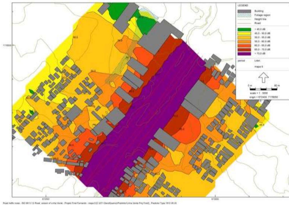
FIGURA 16: NÍVEIS DE PRESSÃO SONORA EQUIVALENTE OBTIDOS ATRAVÉS DE SIMULAÇÃO COMPUTACIONAL PARA O PONTO 9
