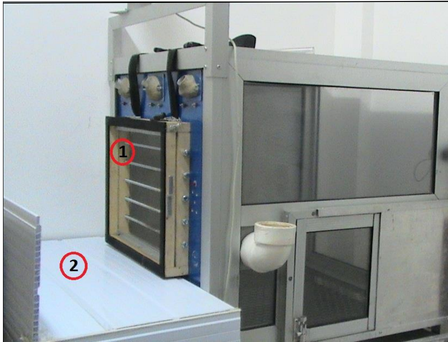
Figura 5. Câmara experimental. O número 1 corresponde à abertura na câmara, por onde o sujeito teve acesso às ferramentas; e o número 2 indica o mini-tablado em cima do qual foram dispostas as ferramentas para o desenvolvimento das tarefas (LOUIS).
