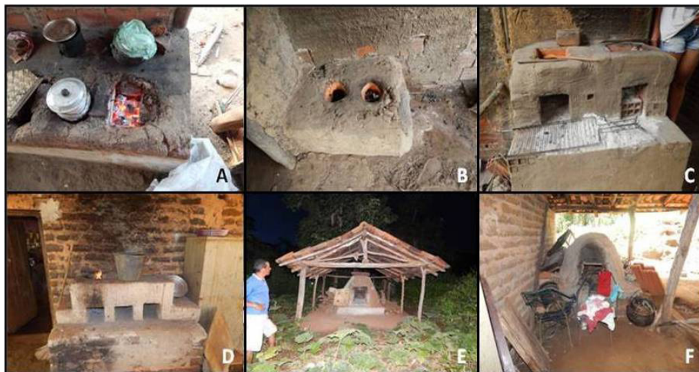
FIGURA 5 – Fogões e fornos de barro à base de carvão vegetal encontrados nas comunidades Chapada do Hamilton e Novo Horizonte, Angical do Piauí/PI. A, B, C e D: Fogões; E e F: Fornos.
