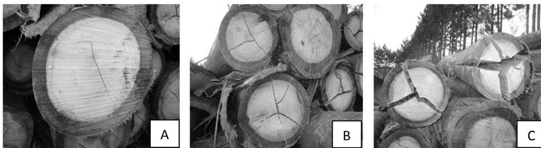
Figura 1. Análise visual da rachadura para determinação do conceito. A: baixo; B: médio; C: alto.
