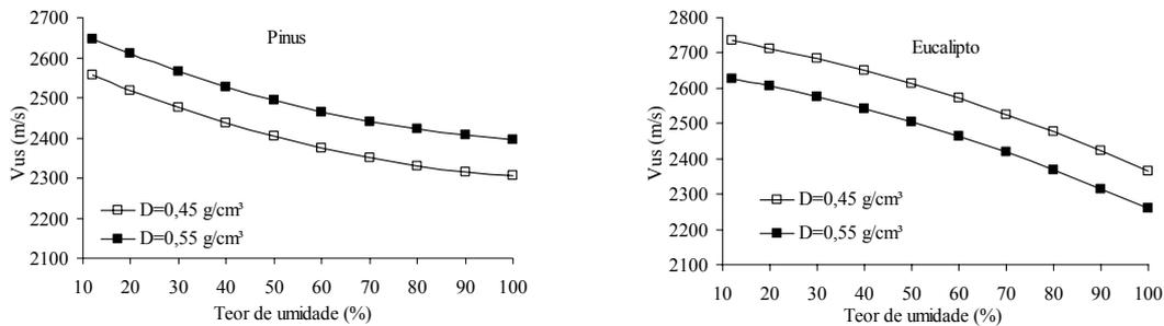
Figura 3. Efeito da massa específica (D) sobre a velocidade ultra-sônica (Vus) para madeiras de *Pinus elliottii* e *Eucalyptus grandis* determinadas com transdutores de pontos secos (temperatura de secagem = 43 °C).
