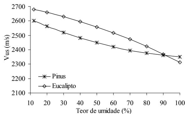
Figura 4. Efeito da espécie sobre a velocidade ultra-sônica (Vus) determinada com transdutores de pontos secos (temperatura de secagem T = 43 °C e massa específica ME = 0,5 g.cm<sup>-3</sup>).
