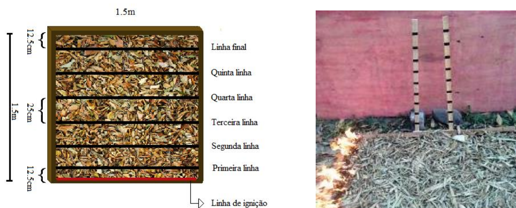
Figura 2. Croqui da mesa de combustão (esquerda) e detalhe das régulas adaptadas para auxiliar na determinação do comprimento das chamas (direita).
