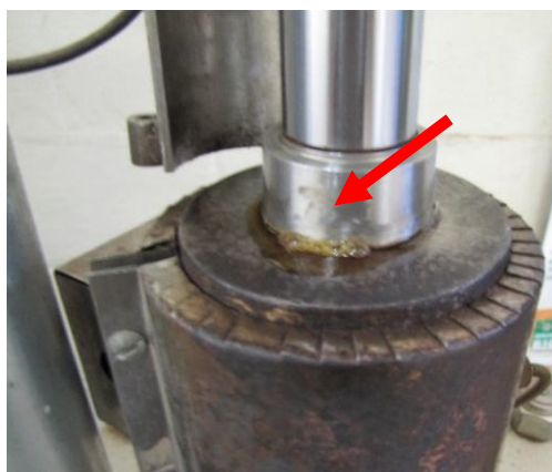
Figure 4. Particle oil (indicated by the red arrow) expelled from the briquetting machine matrix during compaction. Figura 4. Óleo das partículas (indicado pela seta vermelha) expulso da matriz da briquetadeira durante a compactação.
